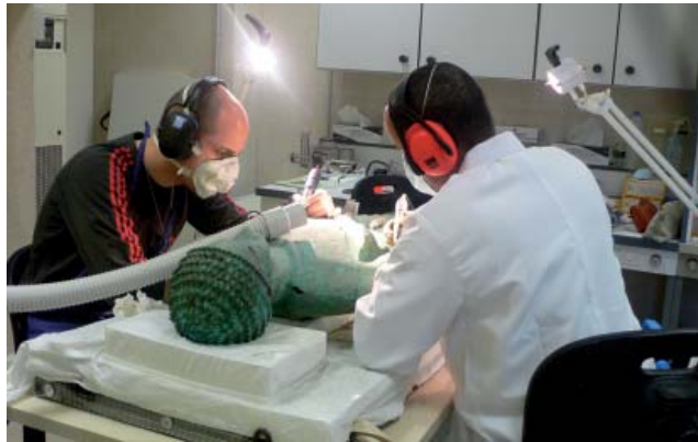
١٣ - التنظيف بمشروط جهاز الترددات الصوتية .
